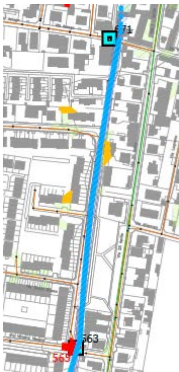
Figura 11: Area con criticità idraulica dovuta alla fognatura T50 - via Guido Rossa
