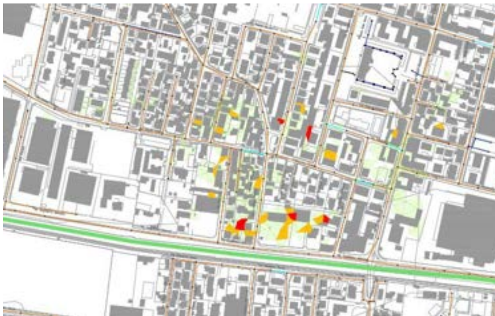
Figura 13: Area con criticità idraulica dovuta alla fognatura T50 – via Tolstoi
