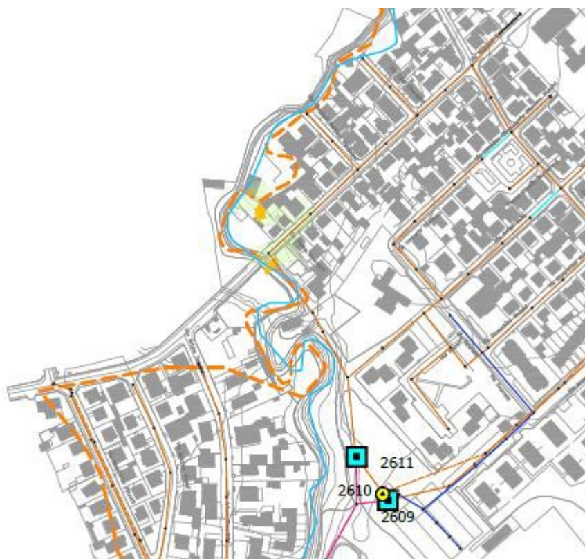
Figura 12: Area con criticità idraulica dovuta alla fognatura T50 – via Mascagni
