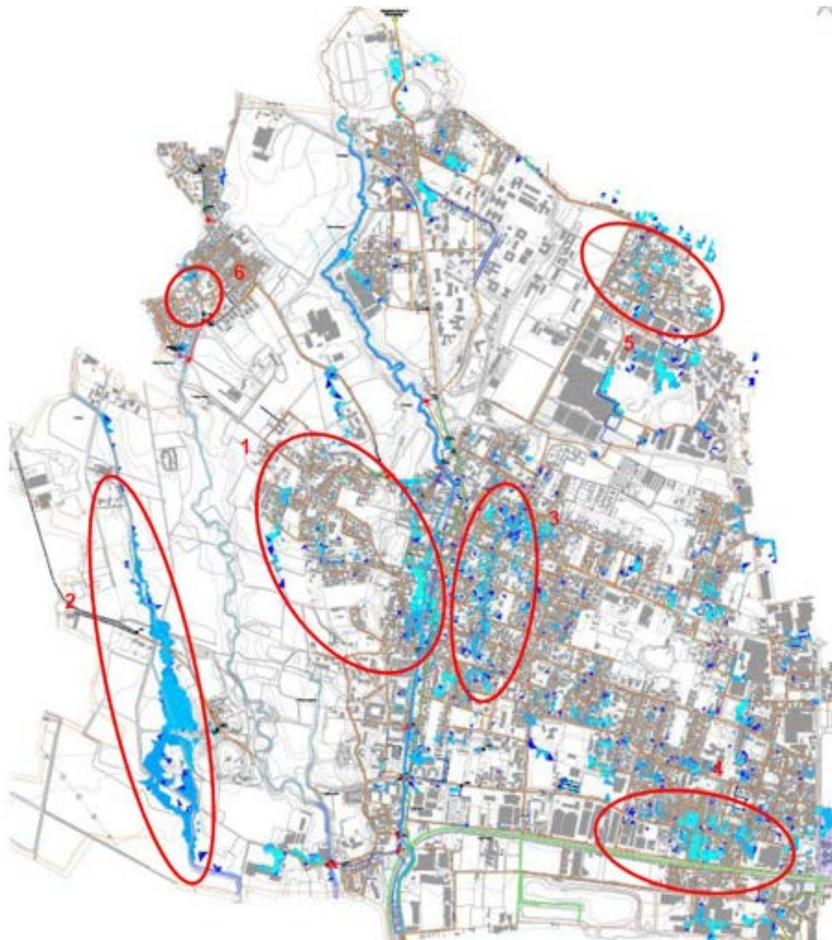
Figura 8: estratto planimetria delle criticità idrauliche T=10, 50, 100 anni con evidenziazione delle zone di allagamento significative
