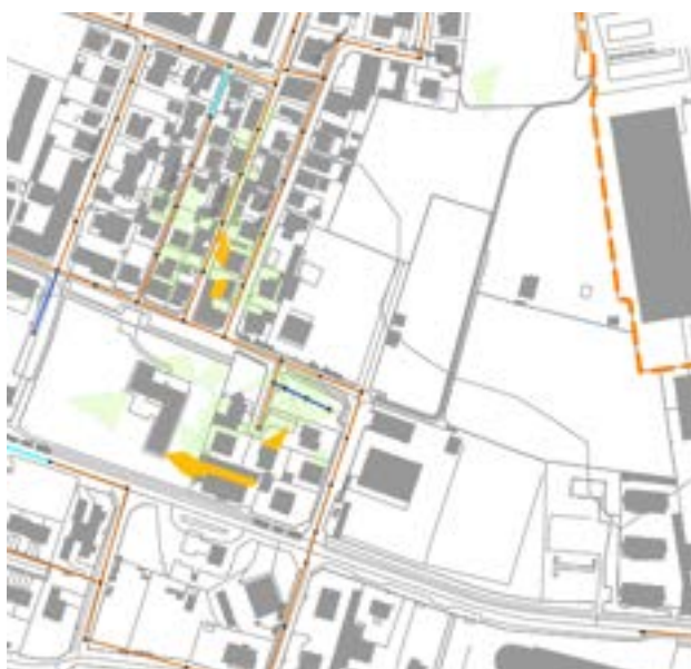
Figura 16: Area con criticità idraulica dovuta alla fognatura T50 – via Roma, via Ravenna
